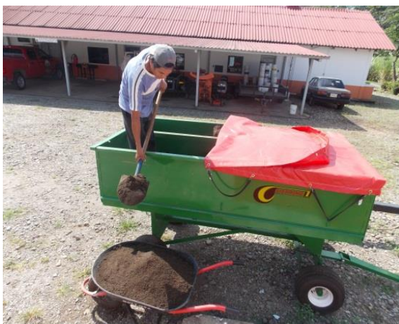
Figura 7.- Tolva de 1 m 3 del pasteurizador.
